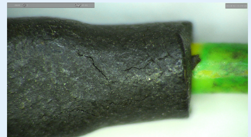
Se identificaron grietas en el aislamiento de terminales durante la inspección con un aumento de 65x
